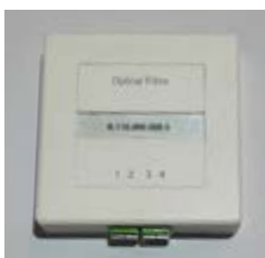
Abbildung 12: Beispiel OTO beschriftet mit der OTO-ID
