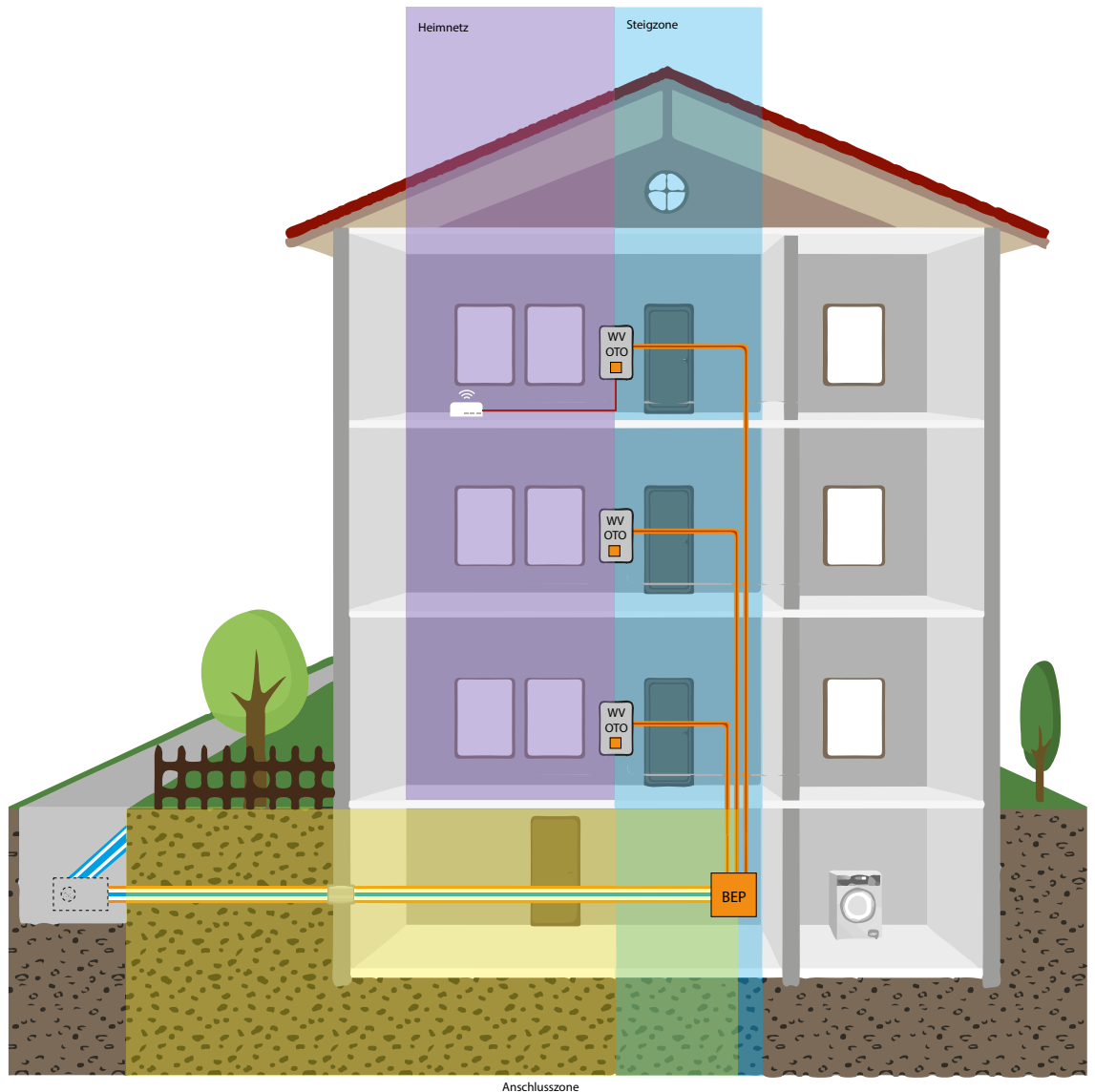
Abbildung 5: Beispiel Mehrfamilienhaus mit sternförmiger Verrohrung in der Steigzone
