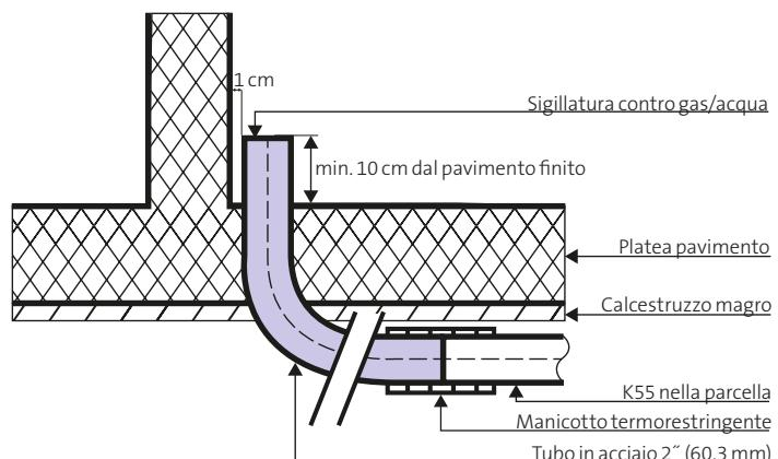
Indipendentemente dal momento del tiro dei cavi, l'inserimento nel fabbricato, nel pozzetto di drenaggio o l'introduzione con tubo in acciaio vanno sempre eseguiti dal committente impermeabili al gas e all'acqua. È esclusa qualsiasi responsabilità di Swisscom per eventuali danni connessi a una realizzazione non a regola d'arte, nella misura consentita dalla legge.
