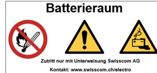
Bild 2.2.3.1: Beschriftung Batterieraum mit Batteriespannung  $\leq 60V$  DC
