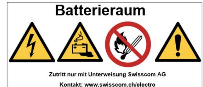
Bild 2.2.3.2: Beschriftung Batterieraum mit Batteriespannung > 60 V DC
