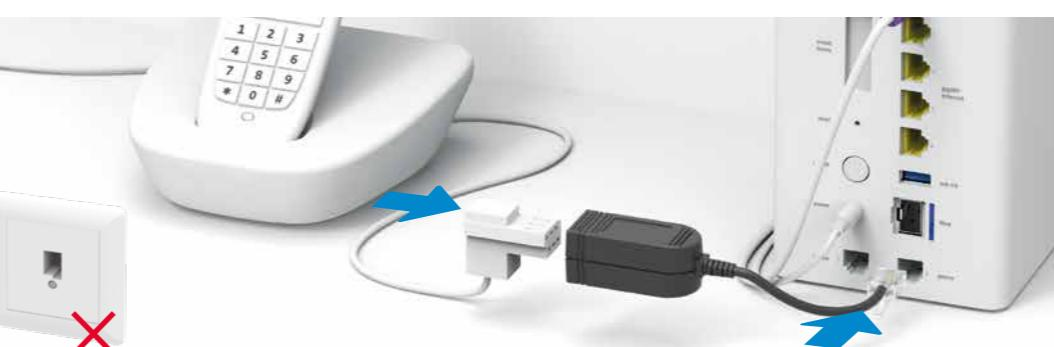
Collegare il proprio telefono/fax solamente all'Internet-Box (phone 1 e 2) – non più alla presa del telefono – se necessario
