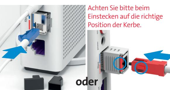
Verwenden Sie das neue Glasfaserkabel. Nehmen Sie die Schutzkappen ab und schliessen Sie das blaue beziehungsweise rote Ende des Kabels an der Internet-Box an. Berühren Sie das Kabel nicht an den Enden.
