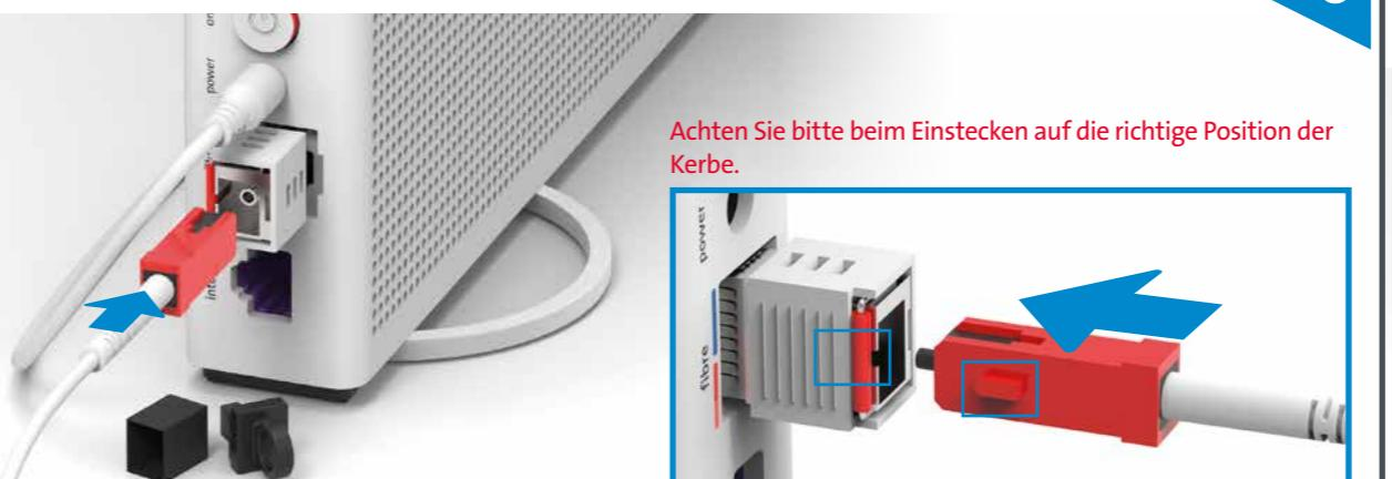
Nehmen Sie die Schutzkappen ab und schliessen Sie das rote Ende des Glasfaserkabels an der Internet-Box an. Das Kabel ist empfindlich. Berühren Sie es nicht an den Enden!
