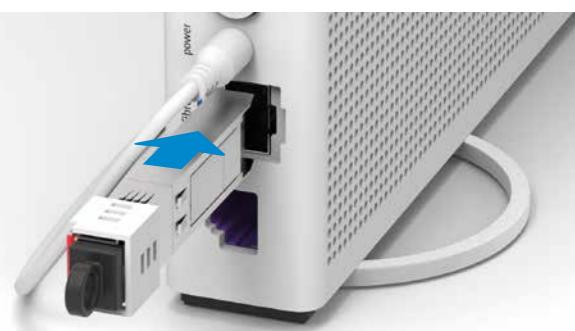
Schieben Sie das Glasfaser-Modul in den «fibre» Einschub ein, bis es einrastet. Die roten Markierungen auf Glasfaser-Modul (Bügel) und Internet-Box gehören auf die gleiche Seite.
