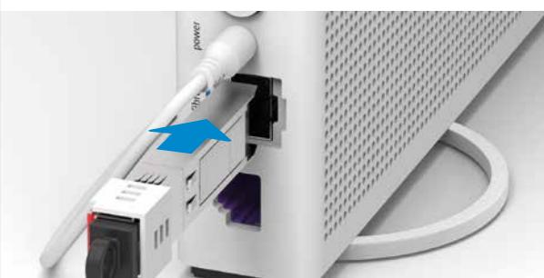
Insérez le module fibre optique dans le port «fibre» jusqu'à ce qu'il s'encastre. Les marquages en rouge sur le module fibre optique (étrier) et l'Internet-Box doivent se trouver du même côté.
