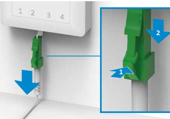
Notez le numéro du slot. Appuyez sur le levier contre la prise (1) et le câble pourra facilement être retiré (2).
