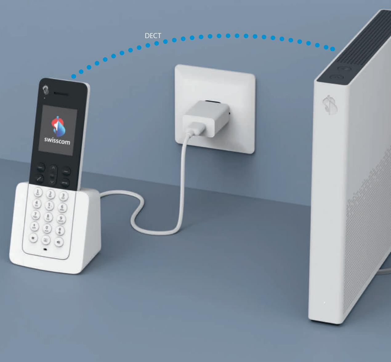
**6** Schliessen Sie die Ladestation an der gewünschten Stromsteckdose oder direkt am USB-Anschluss der Internet-Box an.
