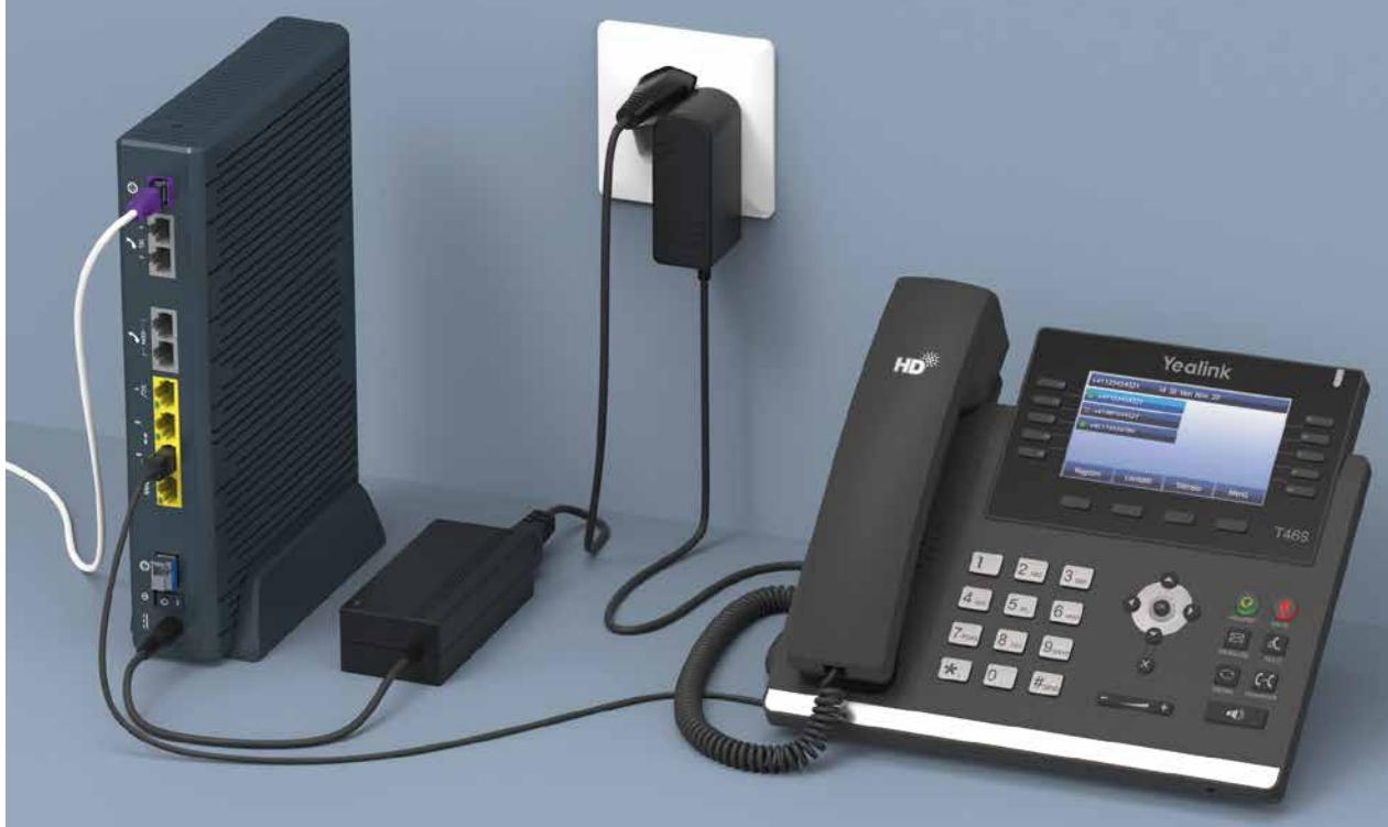
**4** Collegate il telefono al router. A tale scopo utilizzate il cavo Ethernet che vi è stato fornito nella confezione.
