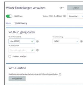
**Sul vostro terminale non compare il nome WLAN?** Gli apparecchi di vecchia generazione possono avere problemi con il nuovo standard WLAN Wi-Fi 6. Aggiornate il driver WLAN dell'apparecchio.
