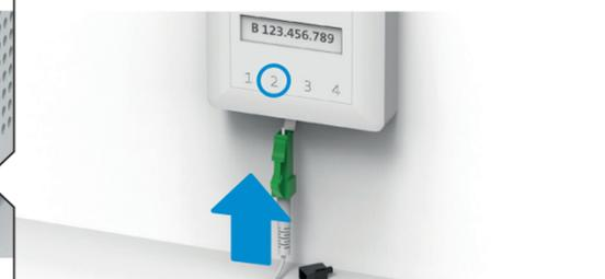
Funziona solo una presa: rimuovere la protezione. Sulla presa per fibra ottica, aprire lo slot specificato nella lettera – normalmente «2», in rari casi «1». Attenzione: se le connessioni sono montate verso l'alto, lo slot 2 è il secondo da destra. Per rimuovere il cavo, v. retro. **②**
