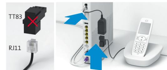
Il vostro connettore ha questa forma (RJ11)? Se non è così, è necessario un adattatore per telefoni RJ11 / TT83 ([swisscom.ch/accessoridicollegamento](http://swisscom.ch/accessoridicollegamento)).
