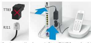
Il vostro connettore ha questa forma (RJ11)? Se non è così, è necessario un adattatore per telefoni RJ11 / TT83 (swisscom.ch/accessoridicollegamento).
