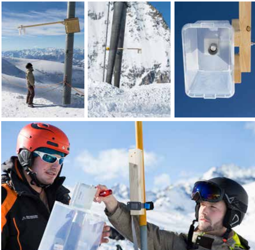
Die Schneehöhe lässt sich mit einfachen Mitteln durchgängig messen.
