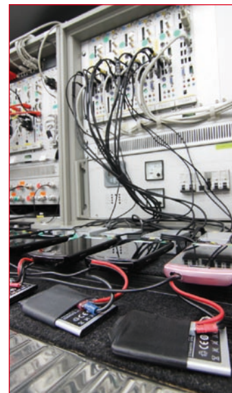
Gut vorbereitet: Ausgebaute Akkus ermöglichen den ferngesteuerten Neustart der Smartphones im Fall von Problemen.
