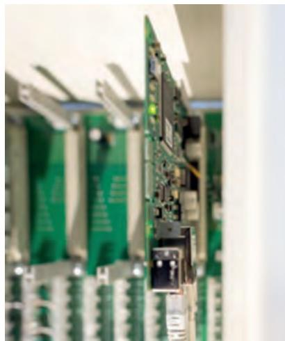
Die Alarmanlage wird mit einem neuen Übertragungs-Modul ausgerüstet, welche die Kommunikation zu IP sicherstellt und die zudem via Mobile Technology einen redundanten Kommunikationsweg aufbauen kann.
