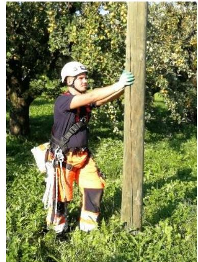
Diese Methode gibt aber nur Anhaltspunkte über den Zustand des Mastes bei trockenem Holz.
