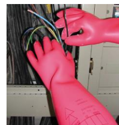
Bild A3.3.2c.7: Isolierhandschuhe Schutzklasse 00 (500V) Schutzklasse 0 (1000V) Schutzklasse 1 (7500V) Schutzklasse 2 (17000V) Schutzklasse 3 (26500V)
