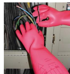
Bild A3.3.2.2b7: Isolierhandschuhe Schutzklasse 00 (500V) Schutzklasse 0 (1000V) Schutzklasse 1 (7500V) Schutzklasse 2 (17000V) Schutzklasse 3 (26500V)
