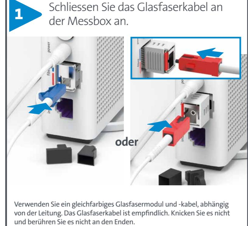
Verwenden Sie ein gleichfarbiges Glasfasermodul und -kabel, abhängig von der Leitung. Das Glasfaserkabel ist empfindlich. Knicken Sie es nicht und berühren Sie es nicht an den Enden.
