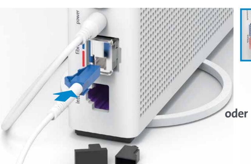
Verwenden Sie ein gleichfarbiges Glasfasermodul und -kabel, abhängig von der Leitung. Das Glasfaserkabel ist empfindlich. Knicken Sie es nicht und berühren Sie es nicht an den Enden.
