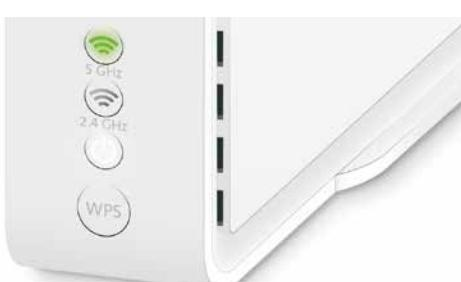
Warten Sie, bis das WLAN-LED wieder leuchtet. Lesen Sie auf der Rückseite unter «**WLAN-LEDs**», > warum **nur ein** WLAN-LED leuchtet und > was zu tun ist, sollte es **rot** leuchten.
