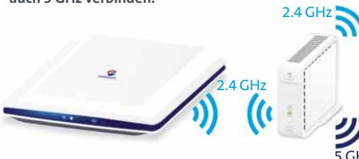
**Hinweis:** Wenn Sie das WLAN des Routers ausschalten, blinkt das WLAN LED des Repeaters rot. Dies ist z.B. der Fall, wenn Sie einen Zeitplan für Ihr WLAN eingerichtet haben (automatische Aus- und Einschaltzeit für Ihr WLAN).
