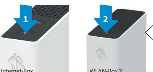
Auch wenn Sie die WLAN-Box 2 per Ethernet-Kabel verbinden, müssen Sie ein Pairing mit den +Tasten durchführen. Beide +Tasten blinken dann weiß.
