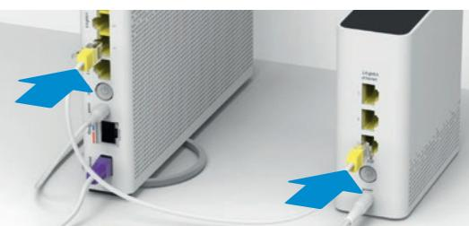
Benutzen Sie das mitgelieferte Ethernet-Kabel oder verbinden Sie die WLAN-Box 2 mit Ihrer Heimverkabelung. Kabelverbindungen zwischen Internet-Box und WLAN-Box 2 garantieren bestmögliches WLAN für Ihre Geräte. Alternativ kann Ihre WLAN-Box 2 (Schritt 5b) per WLAN verbunden werden.
