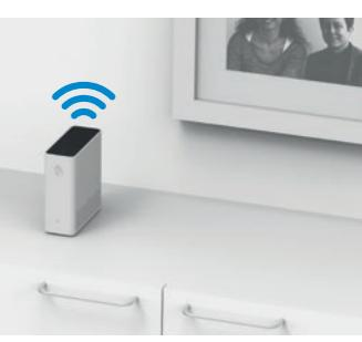
Für bestes WLAN stellen Sie die WLAN-Box 2 vertikal auf (nicht legen) und nicht in unmittelbarer Nähe von anderen Gegenständen und Metallgehäusen.
