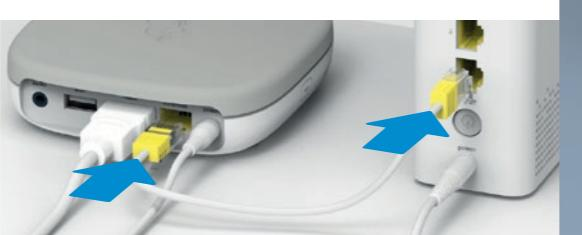
È possibile collegare via Ethernet al WLAN-Box 2 fino a 3 apparecchi. Consultare i consigli sulla «Collegamento via cavo degli apparecchi» sul retro. **①**
