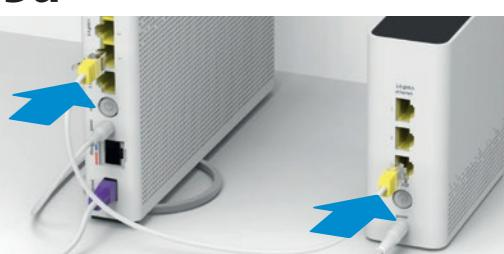
Utilizzare il cavo Ethernet in dotazione o collegare il WLAN-Box 2 al cablaggio domestico. I collegamenti via cavo tra Internet-Box e WLAN-Box 2 consentono di ottimizzare la ricezione WLAN sugli apparecchi. In alternativa, il WLAN-Box 2 può essere collegato via WLAN (punto 5b).
