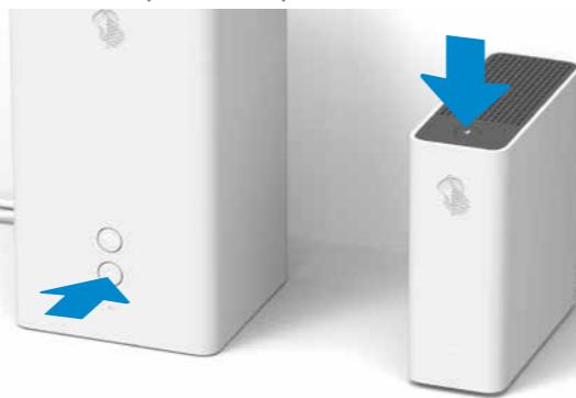
Marche à suivre: appuyez sur les deux touches + (Internet-Box et WLAN-Box) d'ici 2 minutes pour coupler automatiquement les deux appareils.
