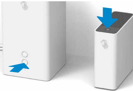
Procedura: premendo i due tasti + (Internet-Box e WLAN-Box) entro 2 minuti i due apparecchi si collegano automaticamente.
