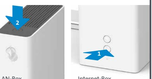
Il pairing con il tasto + dell'Internet-Box va eseguito anche se il WLAN-Box è collegato tramite cavo Ethernet. Entrambi i tasti + lampeggiano di bianco.
