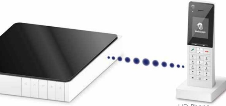
**Hinweis:** Bitte beachten Sie, dass herkömmliche DECT-Schnurlosetelefone nicht oder nur mit eingeschränkter Funktionalität mit der in der Internet-Box integrierten DECT-Basisstation drahtlos verbunden werden können. Wir empfehlen in dieser Situation die kabelgebundenen Anschlüsse «phone 1» oder «phone 2» zu verwenden.
