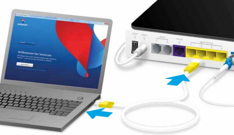
Verwenden Sie das **neue Ethernet-Kabel**. Öffnen Sie im Internet-Browser die Seite [www.swisscom.ch/start](http://www.swisscom.ch/start) und füllen Sie Schritt für Schritt alle Pflichtfelder aus.
