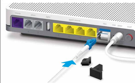
Verwenden Sie das **neue Glasfaserkabel**. Nehmen Sie die Schutzkappen ab, und schliessen Sie das **blaue** Ende des Kabels an der Internet-Box an. Das Kabel ist empfindlich. Berühren Sie es nicht an den Enden!
