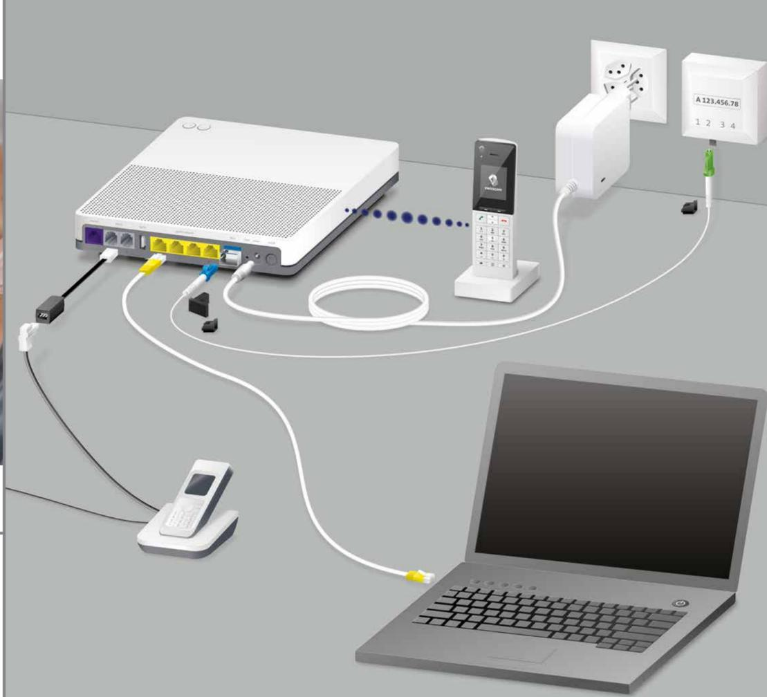
**4** Schliessen Sie das Glasfaserkabel an der Glasfasersteckdose an.
