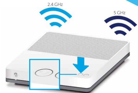
Ihr WLAN können Sie an der **WLAN-Taste** ein- und ausschalten. **Weitere Informationen zu Ihrem WLAN sowie zu den Zugangsdaten (WLAN-Name und Passwort) finden Sie auf der Rückseite.**
