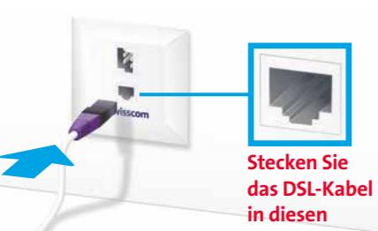
Stecken Sie das DSL-Kabel in diesen Anschluss ein!
