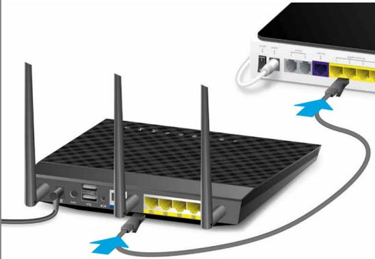
Verwenden Sie dazu das mitgelieferte Ethernet-Kabel. Längere Ethernet-Kabel erhalten Sie im Swisscom Shop.
