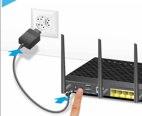
Stecken Sie das Stromkabel ein und drücken Sie auf den Power-Knopf.
