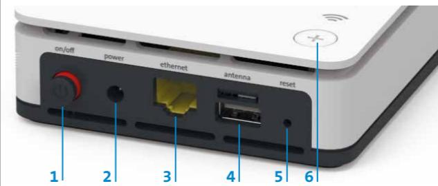
1 **on/off**: mettre en marche et arrêter l'appareil
