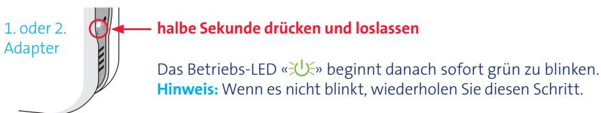
**4** Drücken Sie **ca. eine halbe Sekunde** lang auf den **Pairing Druckknopf** des **neuen Powerline-Adapters**.
