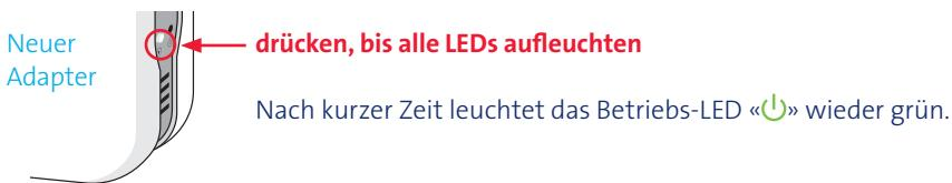
**3** Drücken Sie **ca. eine halbe Sekunde** lang auf den **Pairing Druckknopf** auf einem der **bestehenden Powerline-Adapter**.
