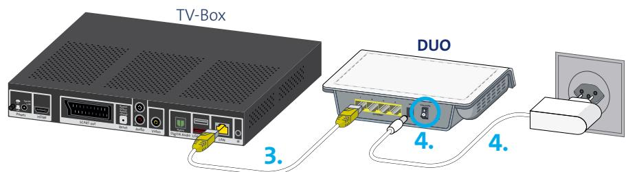
3. Platzieren Sie nun das **zweite DUO-Gerät** neben dem Gerät, das Sie ans Internet anschliessen möchten (hier die Swisscom TV-Box) und verbinden Sie es mit dem Ethernet-Kabel (gelbe Stecker).
