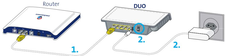
1. Das Universal Verbindungs-Kit DUO besteht aus **zwei genau gleichen Geräten**. Platzieren Sie **ein DUO-Gerät bei Ihrem Router** und verbinden Sie es mit dem beiliegenden Ethernet-Kabel (gelbe Stecker).
