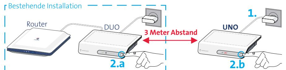
2. **2.a** Drücken Sie die **WPS-Taste** am bestehenden DUO-Gerät (beim Router), und innerhalb weniger Sekunden am neuen UNO-Gerät **(2.b)**. Die Verbindungs-LEDs (✓) beginnen zu blinken und die Geräte verbinden sich selbstständig. **Dies dauert fünf Minuten.** Sobald das ✓ grün leuchtet, ist die Verbindung eingerichtet.
