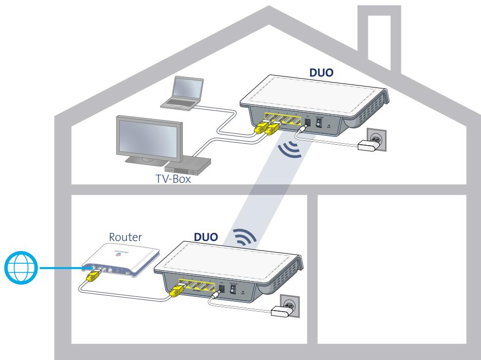
Mit dem **Universal Verbindungs-Kit drahtlos DUO** können Sie bis zu **vier Geräte** mit Ethernet-Anschluss (zum Beispiel die Swisscom TV-Box, Computer oder Spielkonsolen) in einem vom Router-Standort entfernten Raum ans Internet anschliessen.
