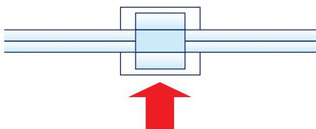
Kabel verlegen: Entlang von Wänden mit Kabel-Clips fixieren.
