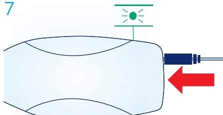
Beide Medienkonverter über Netzteile an Strom anschliessen.
