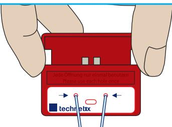
Beide Kabelenden für optische Verbindung schneiden. Dazu obere Schneideöffnungen verwenden.
