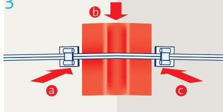
Bei Verlegung um Ecken Schablone verwenden. Schritte **a** bis **c** beachten. Schablone entfernen.
