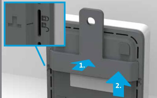
Legen Sie die Haken in die Öffnungen, und schieben Sie zum Arretieren den Montagebügel nach oben.
