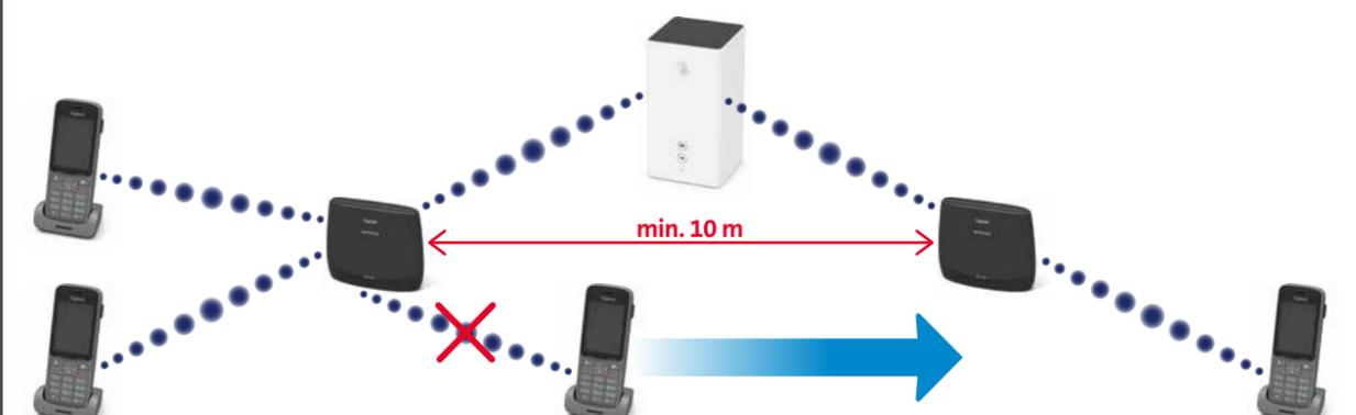
Assurez-vous que pour aucun répéteur, plus de deux HD-Phones ne sont connectés. Les HD-Phones se connectent automatiquement au signal DECT le plus puissant. Si deux HD-Phones y sont déjà connectés, un conflit de connexion se produit avec les appels entrants.
