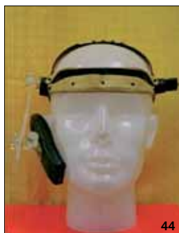
44 Kopfphantom für die Bestimmung des SAR-Wertes
