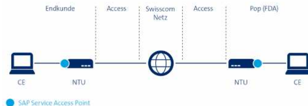
Abbildung 1: Übergabe des Dienstes CLS ausserhalb Swisscom Anschlusszentrale
