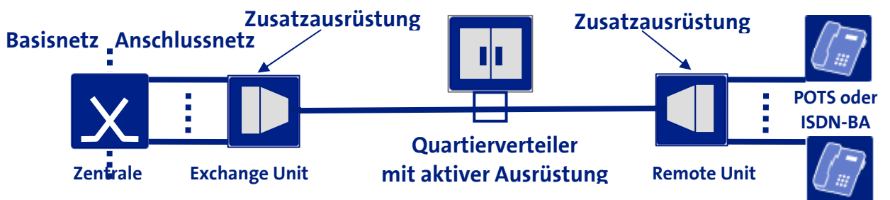
Abbildung 2: Schematische Darstellung von Zusatzausrüstungen im Anschlussnetz
