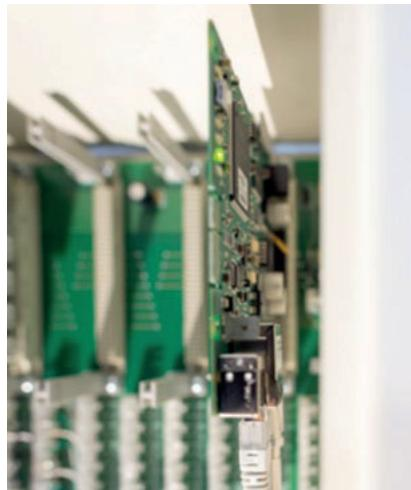
Le système d'alarme est équipé d'un nouveau module de transmission qui assure la communication vers IP tout en établissant une voie de communication redondante via la technologie mobile.
