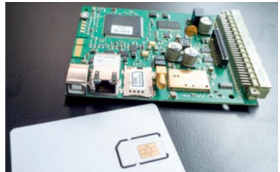
A l'aide d'ébauches de cartes SIM M2M, CDS SA ne configure ses cartes que peu avant la mise en service. La gestion des cartes s'effectue simplement via la plate-forme CMP de Swisscom.
