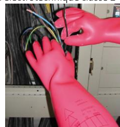
Figure A3.3.2.2c7 : Gants isolants Classe de protection 00 (500 V) Classe de protection 0 (1000 V) Classe de protection 1 (7 500V) Classe de protection 2 (17 000 V) Classe de protection 3 (26 500V)
