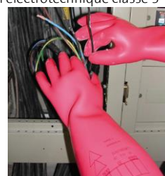
Figure A3.3.2.2d7 : Gants isolants Classe de protection 00 (500 V) Classe de protection 0 (1000 V) Classe de protection 1 (7 500V) Classe de protection 2 (17 000 V) Classe de protection 3 (26 500V)
