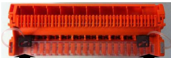
Figure R4.1.6b1: Lames à braser avec gaine thermorétractable orange
