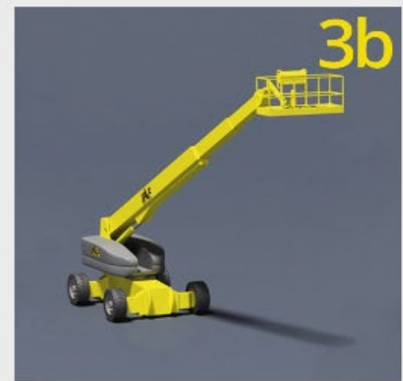
3b PME à flèche (mobile boom)
