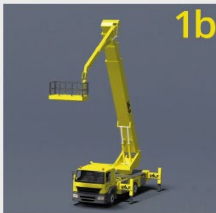
1b PEM à flèche (statique boom)
