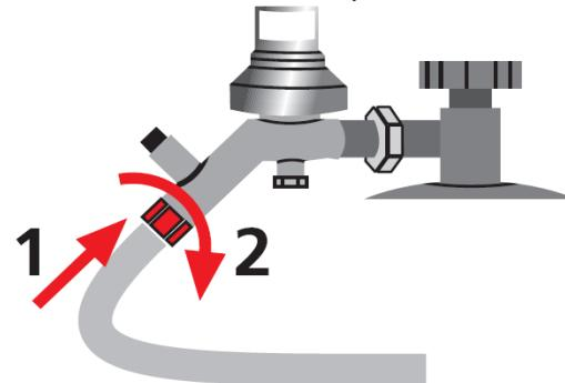
C. Visser le flexible de raccordement sur le détendeur.
