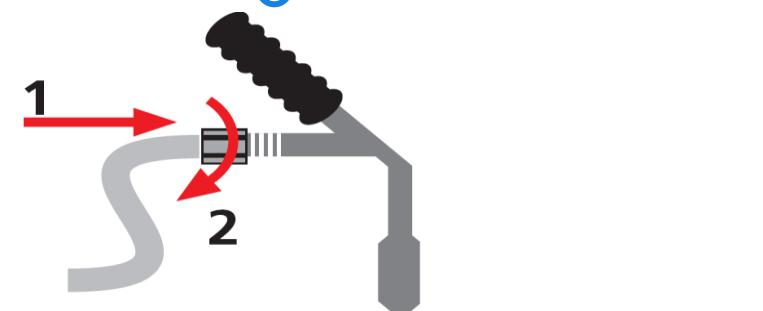
B. Visser le flexible de raccordement sur le robinet de l'outil.
