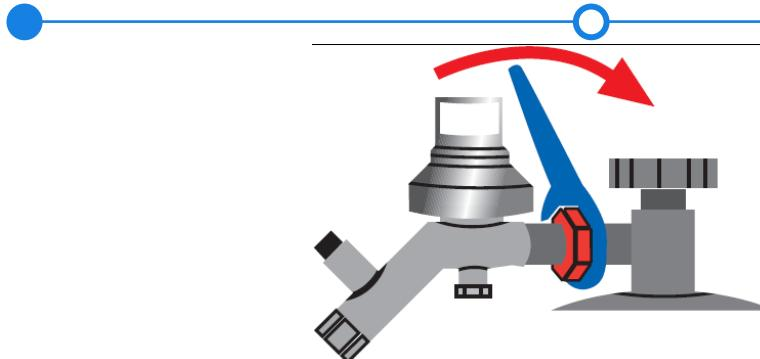
A. Visser le détendeur sur le robinet de la bouteille et serrer les écrous-raccords avec la clé plate.
