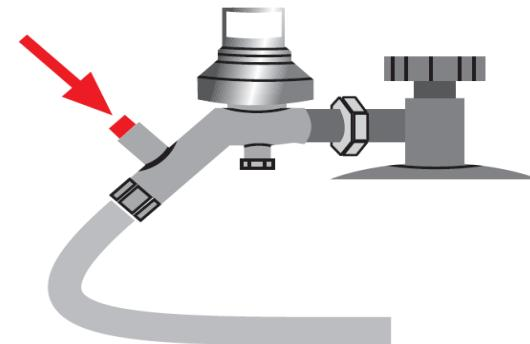
D. Ouvrir le robinet de la bouteille lorsque le robinet de l'outil est fermé et appuyer sur le bouton-poussoir en fonction de la longueur du flexible. Le bouton-poussoir pour le contrôle de l'étanchéité ne doit pas être maintenu appuyé mécaniquement.
