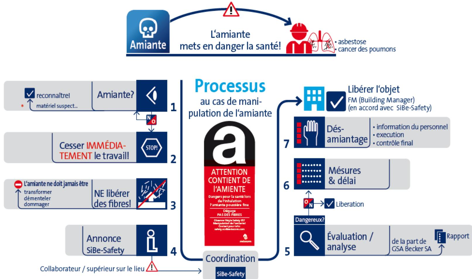
\* Les travaux avec des produits à base d'amiante faiblement agglomérés sont très dangereux. En effet, ces produits peuvent facilement libérer des fibres, d'où une concentration importante de fibres dans l'air.
