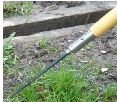
4 essais qui doivent être effectués avant de monter: a. Contrôle visuel; b. Essais de frappe; c. Essais de poussée et d. Essais avec un testeur de poteau. Seulement ainsi, un nombre conséquent d'accidents peut être prévenu!
