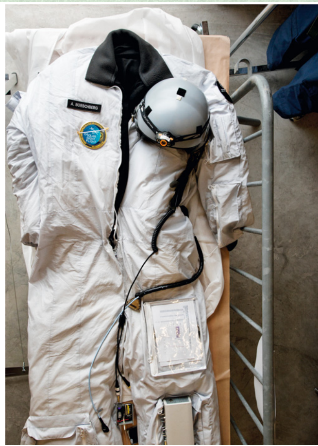
L'avion n'a ni chauffage ni climatisation, d'où la nécessité d'une COMBINAISON THERMIQUE pour le pilote. Elle permet d'équilibrer les variations de température extrêmes dans le cockpit: +40 DEGRÉS et -20 DEGRÉS en se gonflant et dégonflant à la demande du pilote.
