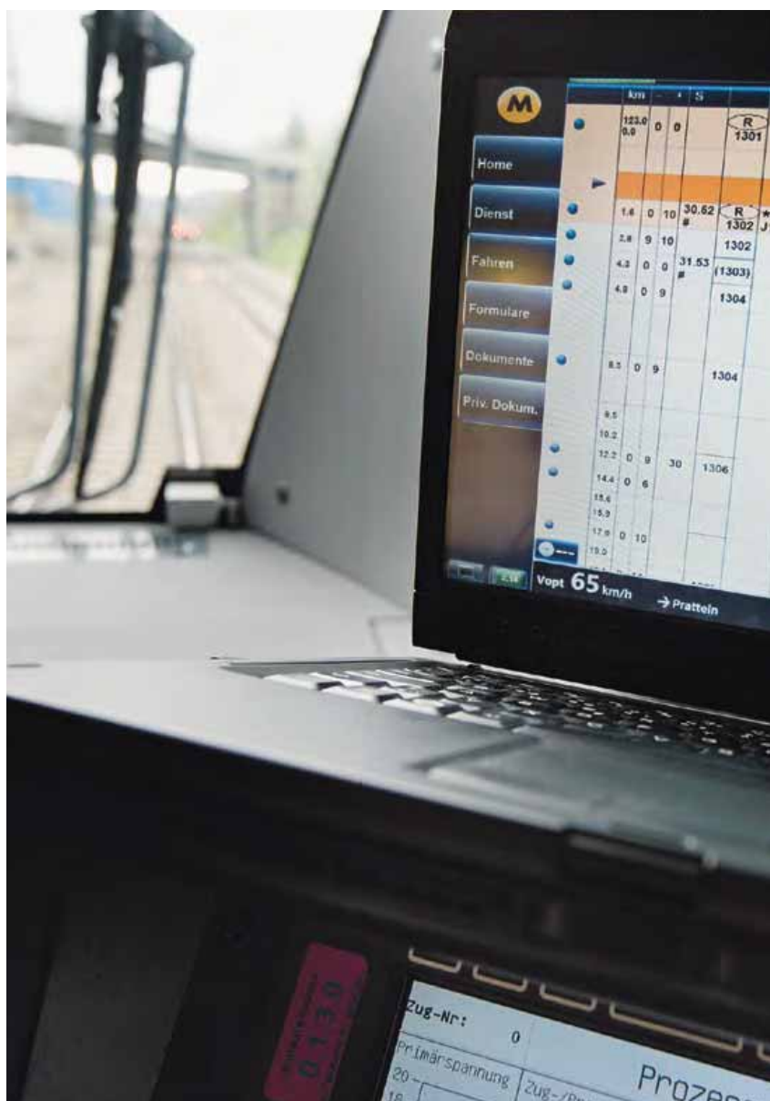
L'écran ADL de la cabine de conduite d'un train
