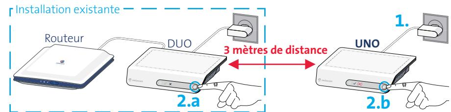
2. 2.a Pressez la **touche WPS** (WPS) sur l'appareil DUO existant (près du routeur) et, après quelques secondes, sur le nouvel appareil UNO (2.b). Les LED de connexion (✓) commencent à clignoter et les appareils se connectent de manière autonome. **Cette procédure dure cinq minutes**. Dès que ✓ passe au vert, la liaison est établie.
