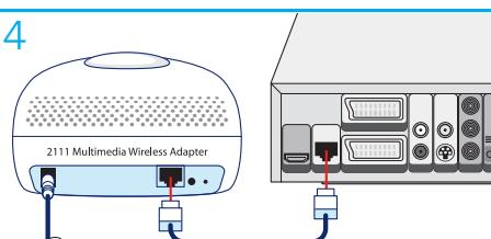
Raccordez l'adaptateur sans fil multimédia 2111 à la Swisscom TV-Box avec le câble Ethernet.
