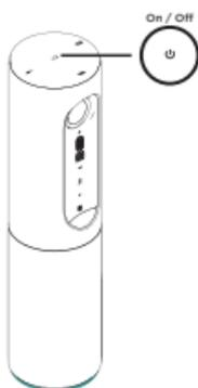
2. Appuyez longuement sur le bouton Marche/Arrêt pour mettre le dispositif sous tension. Le dispositif émet un signal sonore et les témoins lumineux s'allument pendant 2 à 3 secondes. Le témoin lumineux du dernier mode utilisé reste allumé.
