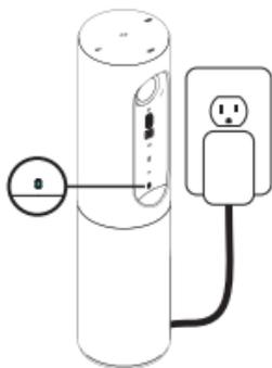
1. Branchez ConferenceCam Connect à une source d'alimentation externe. Bien que le système ConferenceCam Connect soit fourni avec une batterie rechargeable, il doit d'abord être branché à une source d'alimentation externe et chargé jusqu'à ce que le témoin lumineux vert de batterie s'allume.
