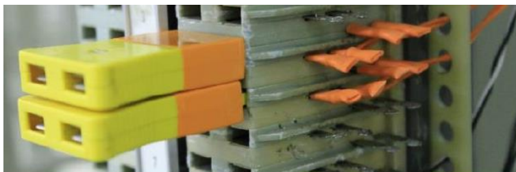
Figura R4.1.6b1: Linguetta di saldatura con guaina termoretrattile arancione
